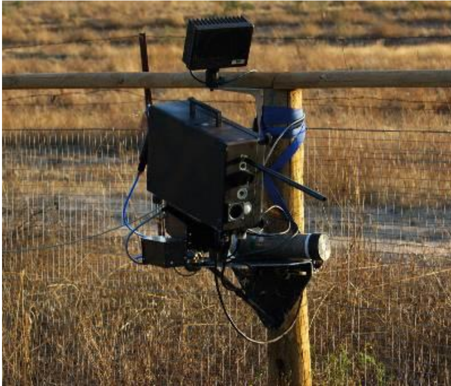
Sistema de tele-anestesia por control remoto diseñado por el KORA, instalado en un cercado de alimentación suplementaria de lince ibérico. El sistema posee cámara, luz de infrarrojos y una pistola de tele-anestesia. (Foto: Guillermo López)
